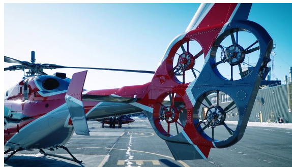
Figure 1: Hélicoptère Bell 429 équipé de rotors de queue carénés EDAT.
